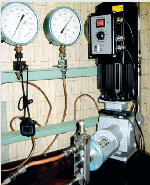
Рис. 1. Дозировочный насос НД 1,ОР 10/100 К 13 МА с приводом Varicon на испытательном стенде
